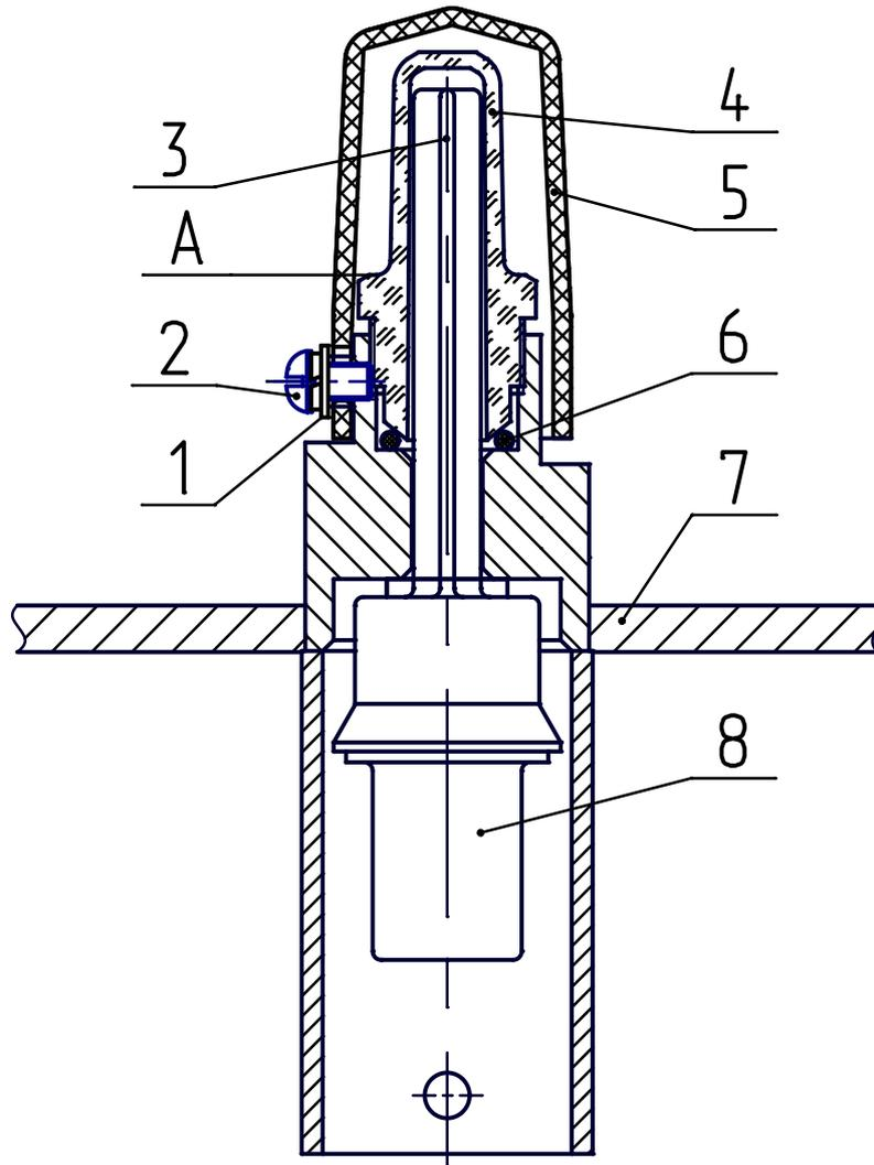
1 - шайба; 2 - винт; 3 - красный сигнальный шток; 4 - прозрачный колпак; 5 - прозрачный защитный колпак; 6 - кольцо уплотнительное; 7 - крышка трансформатора; 8 - поплавок
