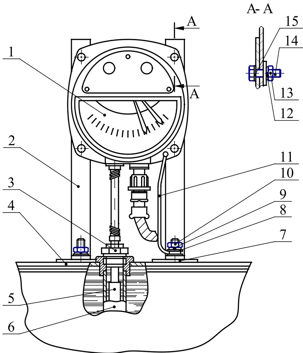
1- манометрический термометр; 2 - уголок; 3 - зажимная гайка;
