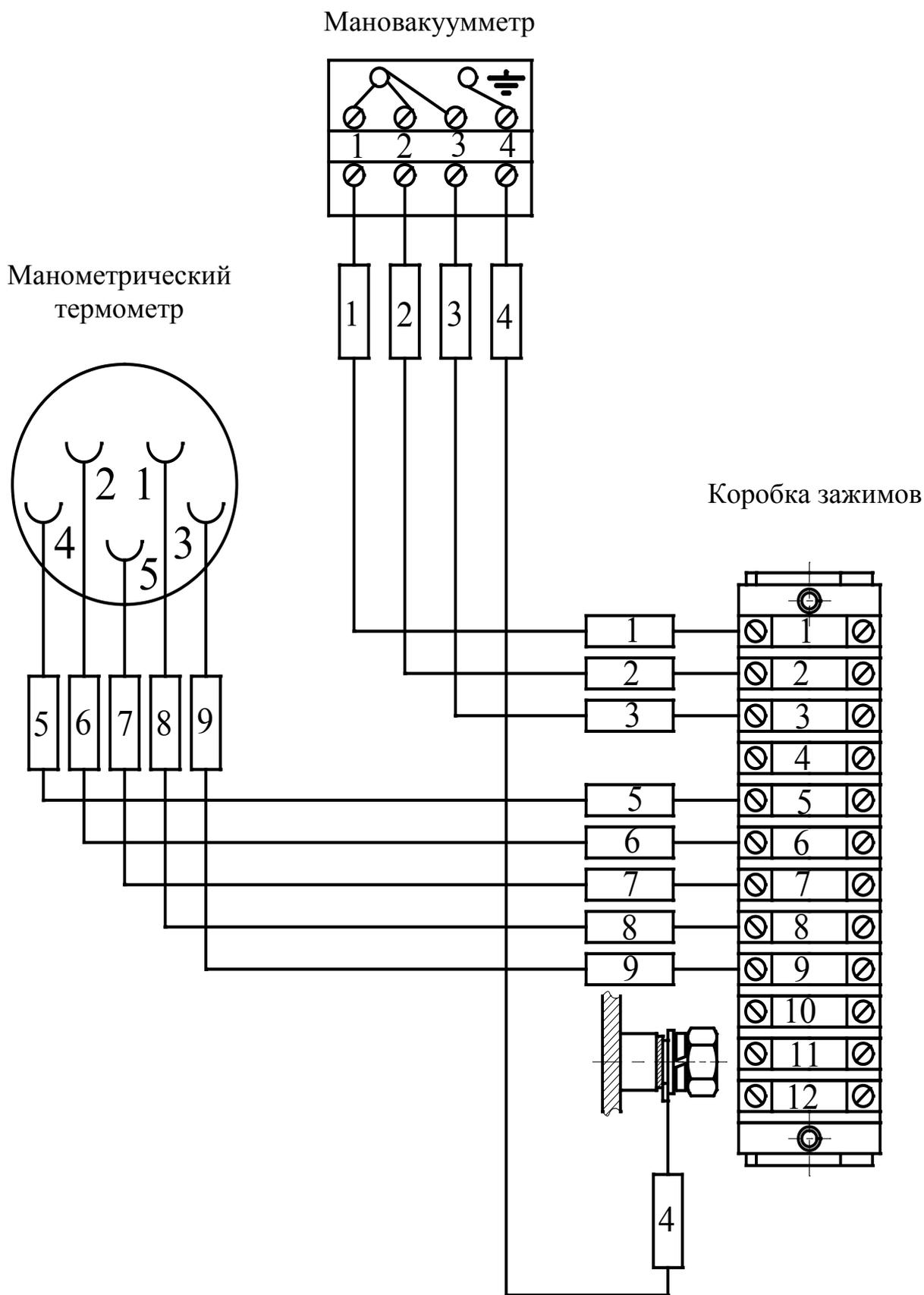
Рисунок А.14 – Монтажная схема соединения коробки зажимов с контрольно-измерительными приборами
