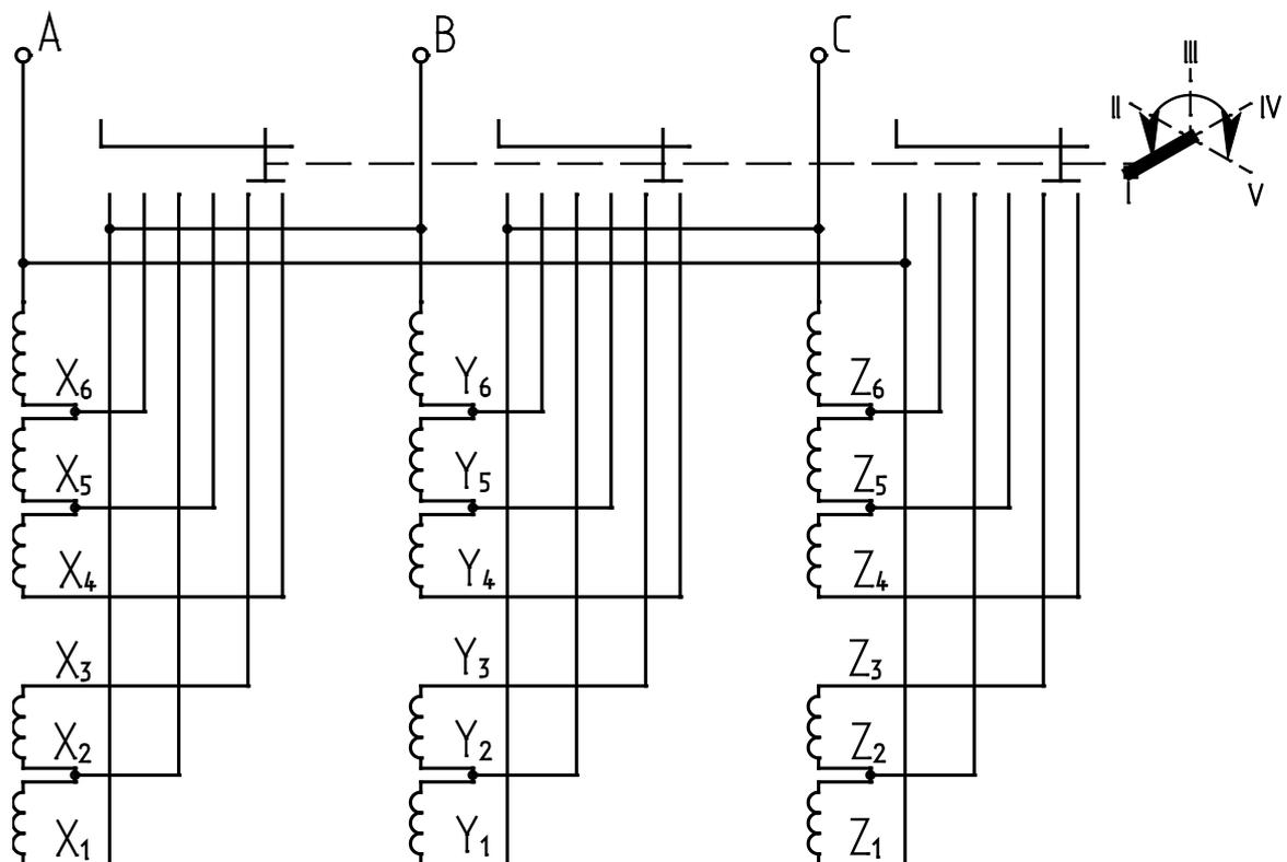
Рисунок А.9 – Схема подсоединения ответвлений обмоток ВН к переключателю при схеме соединения обмоток – «ТРЕУГОЛЬНИК»
