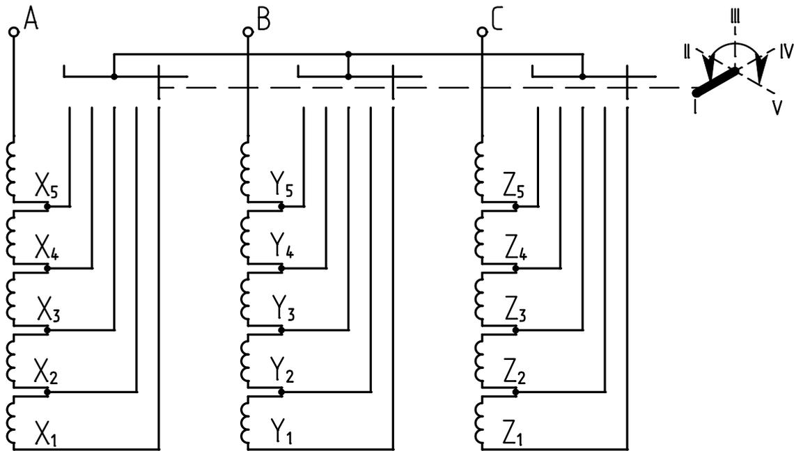
Рисунок А.8 – Схема подсоединения ответвлений обмоток ВН к переключателю при схеме соединения обмоток – «ЗВЕЗДА»
